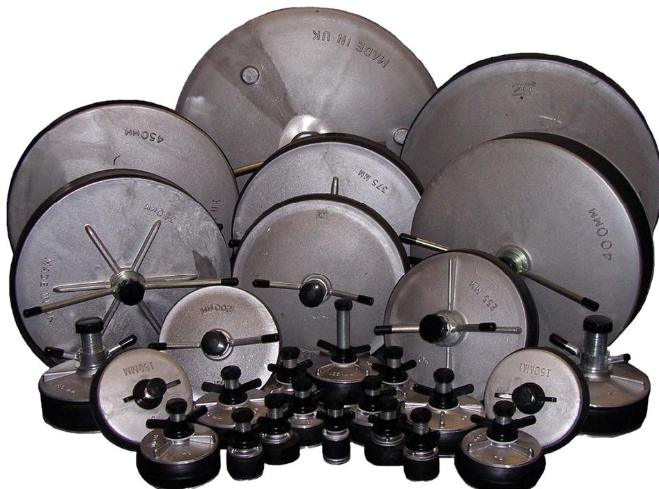
Die mechanisch verstellbaren Absperrscheiben aus Aluminium sind perfekt zum Absperren und Testen von Rohrleitungen geeignet. In den Größen ab 38 mm bis 900 mm ID sind diese für alle Rohrarten geeignet: Sowohl als Formiergasstopfen bei Schweißanwendungen, als auch für Dichtheitsprüfungen im Niederdruckbereich oder zum einfachen Schutz vor Flüssigkeiten, Fremdkörpern etc.
