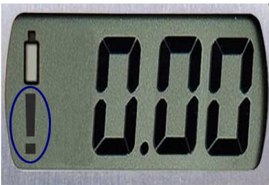
Wenn das Symbol „!“ im Display erscheint, wird es notwendig, den Sensor baldmöglichst auszutauschen. Dank dieser neuen Funktion bleibt Ihnen genug Zeit, einen neuen Sensor zu bestellen. Ein Weiterarbeiten ohne kostenintensive Standzeiten ist somit gewährleistet.
