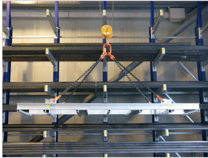
angebrochene Bunde lagern sicherer in System-Kassetten-Regalen
