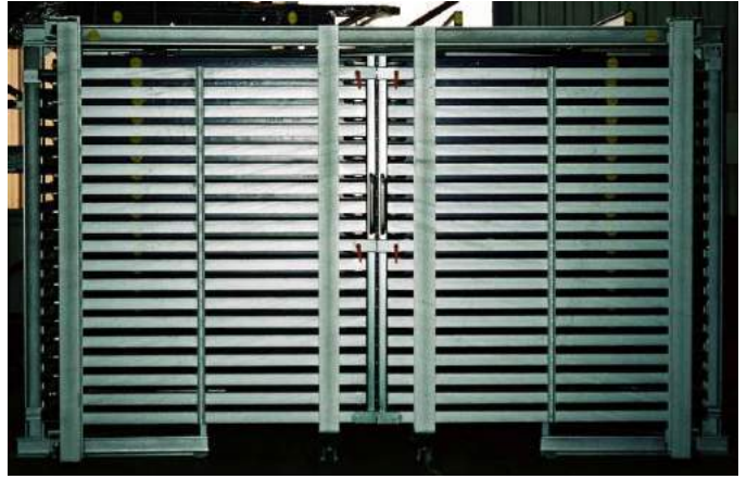
19 Schwerlast-Schubladen / Wechselwagen mit einschwenkbaren Auszugs-Rollwangen
