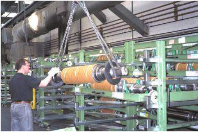
Schwerlast-Schubladen mit Inlets für Walzen mit empfindlicher Oberfläche
