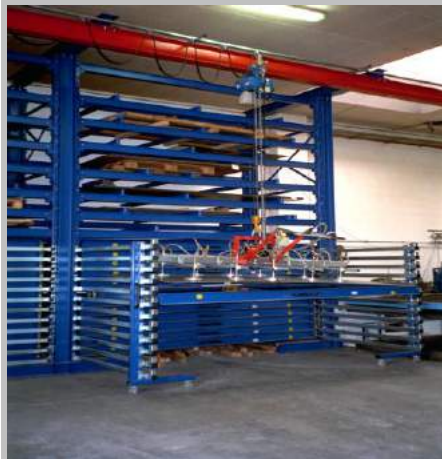
TwenTower Auszug elektromotorisch 5 t pro Schubboden 4.000 x 4.000 mm
