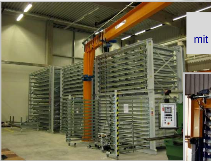
TwenTower Auszug elektromotorisch 5 t pro Schubboden 4.000 x 4.000 mm
