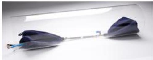
7. Nach Abschluss des Schweißvorgangs die Gaszufuhr schließen, um die Spülblasen zu entleeren. Wenn sich die Wärmeeinflusszone ausreichend abgekühlt hat und die Spülblasen entleert sind, das I-Purge System aus dem Rohr entfernen. Sicherstellen, dass alle Gasleitungen und Überwachungsgeräte vom System getrennt wurden.
