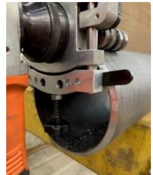
Mit dem Anfaswerkzeug X-PIPE erweitern wir die Möglichkeiten unserer Schweißkantenfräsen B10 Elektra – B15 Elektra und B15 Air um eine weitere Dimension.
