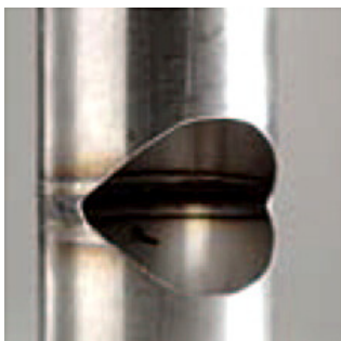
Maschinell geschweißte Naht ungespült
