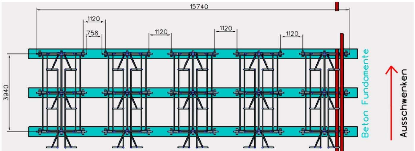
Zur Aufnahme größerer Profile dienen die **10 Auflagen** über den Schwenkauslegern, die mit jeweils **500 Kg** belastet werden können.
