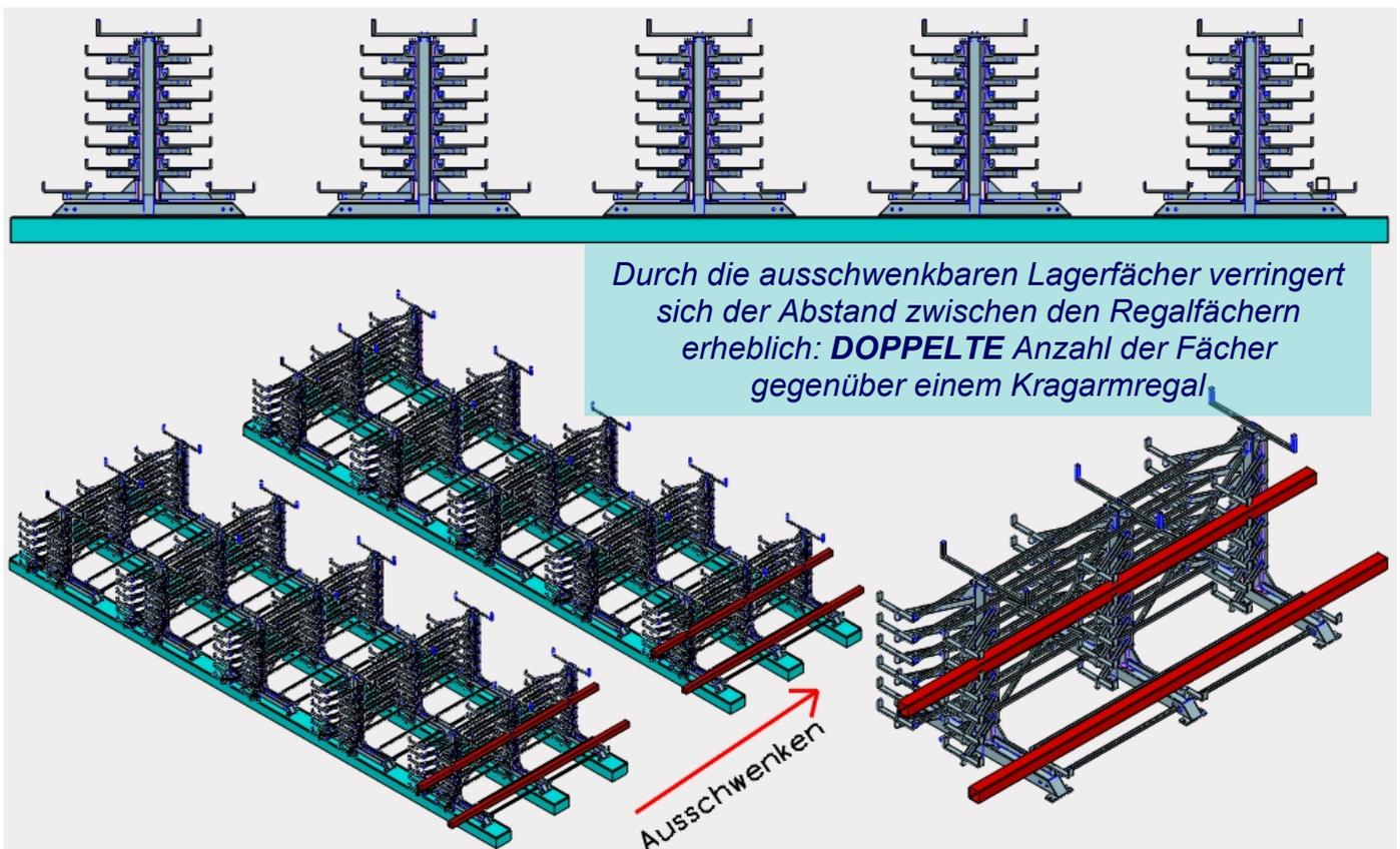
Die schwenkbaren Lagerfächer erleichtern die Be- und Entladung der Regale und machen das Arbeiten sicherer, weil das Material mit dem Kran direkt von oben in das Ablagefach gelegt wird.
