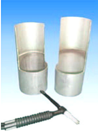
Manuelle Schweißnähte gespült (links) ungespült (rechts)
