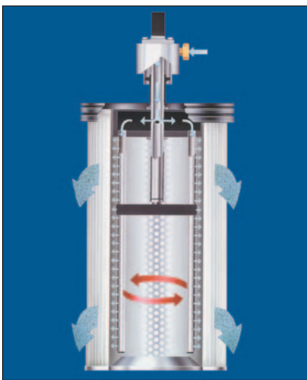
Bei der Tiefenfiltration dringen die Schadstoffe in das Filtermaterial ein. Eine Abreinigung ist praktisch nicht möglich.
